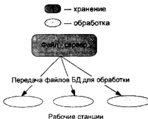
Рис. 3. Схема обработки информации в БД по принципу файл-сервер
