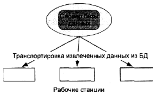
Рис. 4. Схема обработки информации в БД по принципу клиент-сервер
